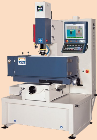
放電加工設備
